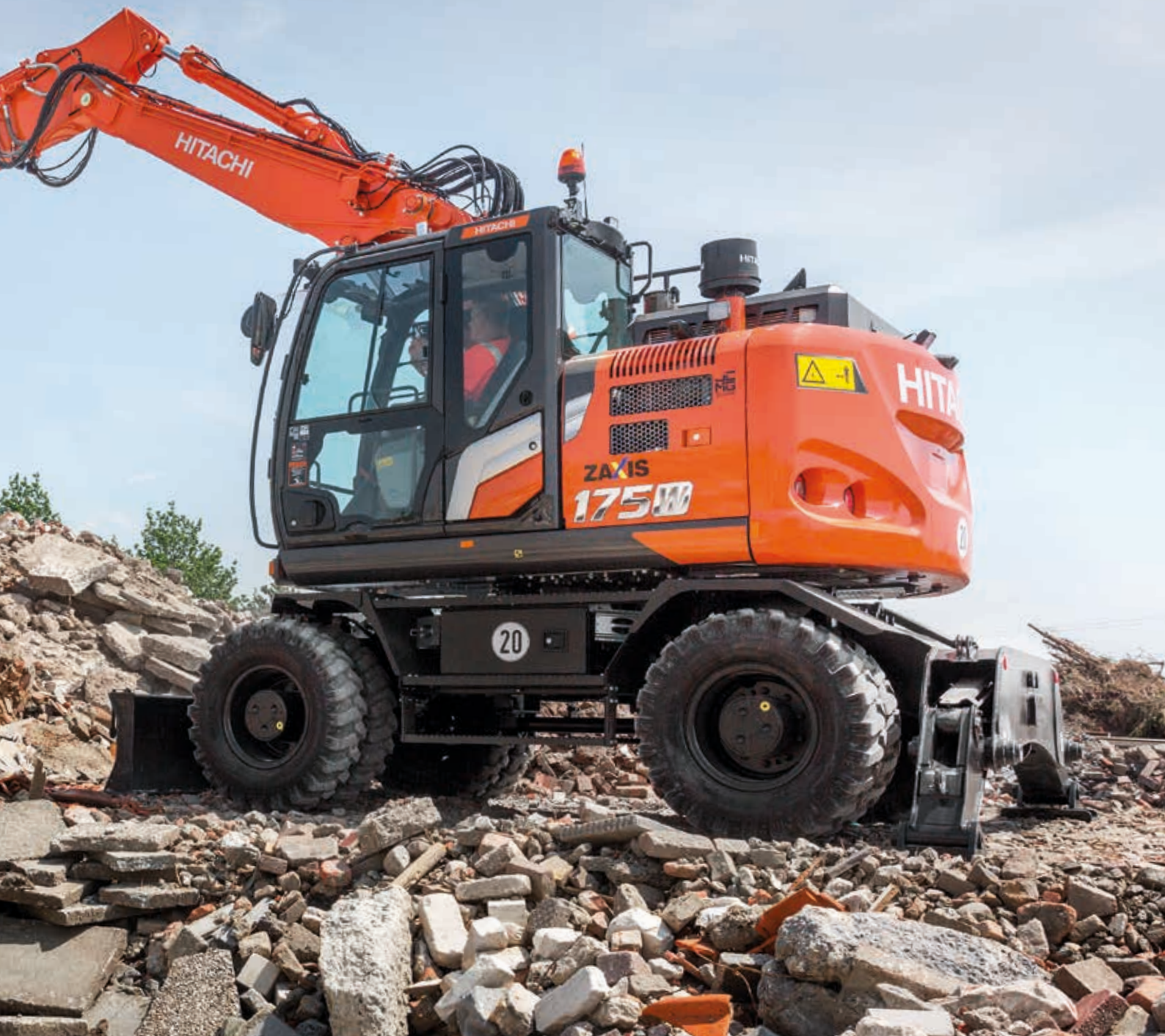
HIOS V -hydraulijärjestelmä lisää kaivulaitteen nopeutta ja alentaa polttoaineen kulutusta.
