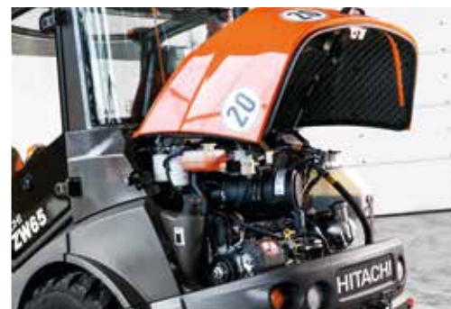
Helposti avattava moottoritilan kansi nopeuttaa huoltoja.
