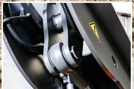
Letkujen ja johtojen veto rakenteiden sisällä suojaa tärkeitä osia.
