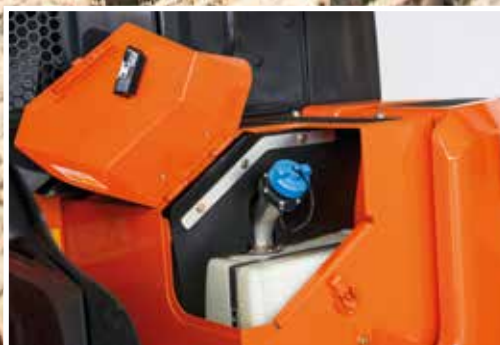
Ureaa ruiskutetaan pakokaasun sekaan vähentämään päästöjä.
