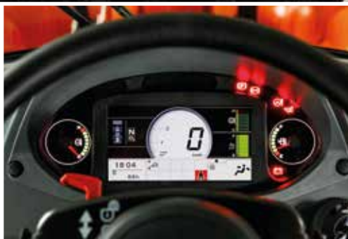
LCD-näyttö näyttää koneen tilan ja asetukset.
