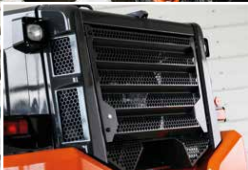
Uusi takasäleikkö suojaa jäähdytintilaa.
