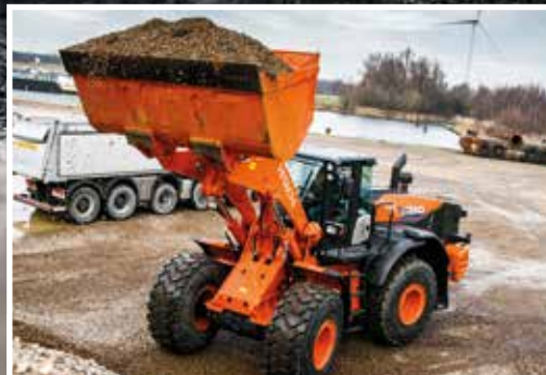
Virtauksenohjausjärjestelmä varmistaa nostovarren pehmeät liikkeet.
