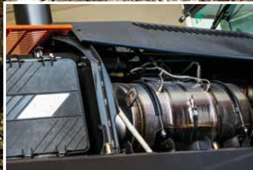
SCR-järjestelmä vähentää päästöjä ja alentaa melutasoa.
