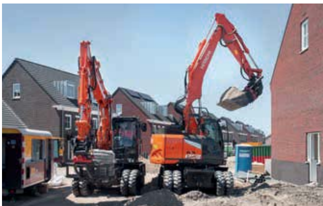
ZX135W-7 kääntyy 3,5 metrin tilassa (perä 1 740 mm ja etupuoli 1 750 mm).
