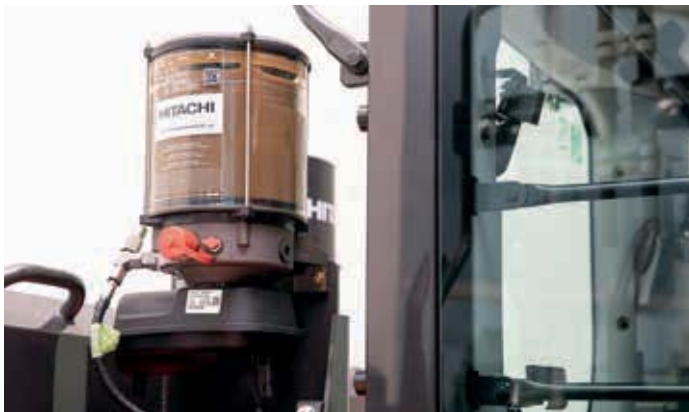
Lisävarusteena tarjolla oleva automaattinen voitelulaite säästää aikaa.
