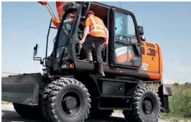
Ensimmäisen askelman sijoittaminen alemmas, tekee ohjaamoon noususta turvallisempaa ja helpompaa.
