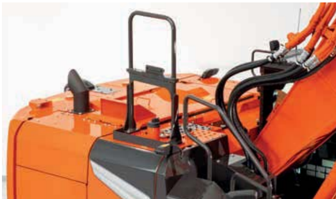
ZX225US/USR-7:n uusi kaide on sisäänvedettävä, mikä helpottaa kuljetusta.
