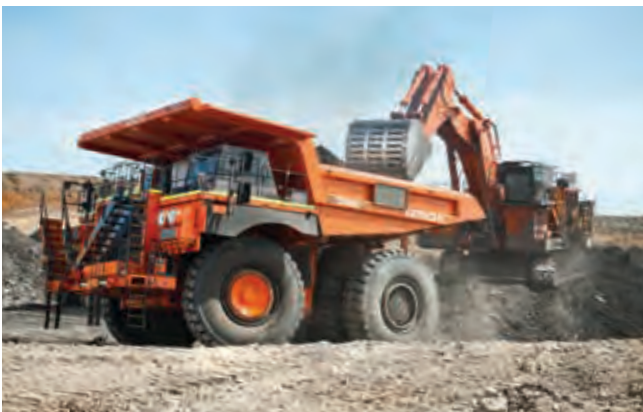
EH-dumpperit ja erikoissuuret EX-kaivukoneet
