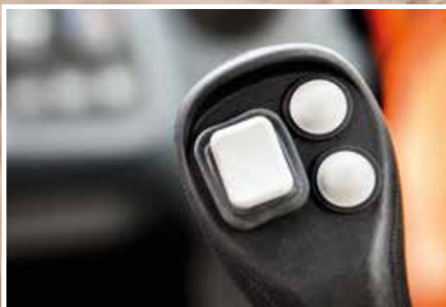
Tehonlisäyskytkin antaa tarvittaessa nopeasti lisävoimaa.
