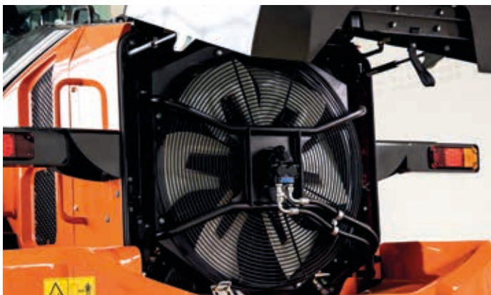
Älykäs jäähdytyspuhallinten ohjausjärjestelmä estää jäähdytinten tukkeutumisen.
