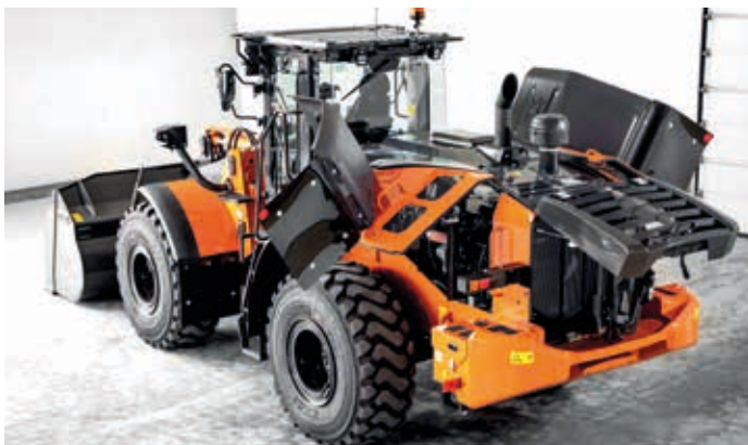
Moottoritilan kansien ansiosta päivittäiset tarkastuskohteet ovat hyvin esillä.
