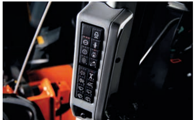
Kaikki yleisimmin käytettävät toiminnot voidaan valita nopeasti sivulla olevan kytkinpaneelin avulla.
