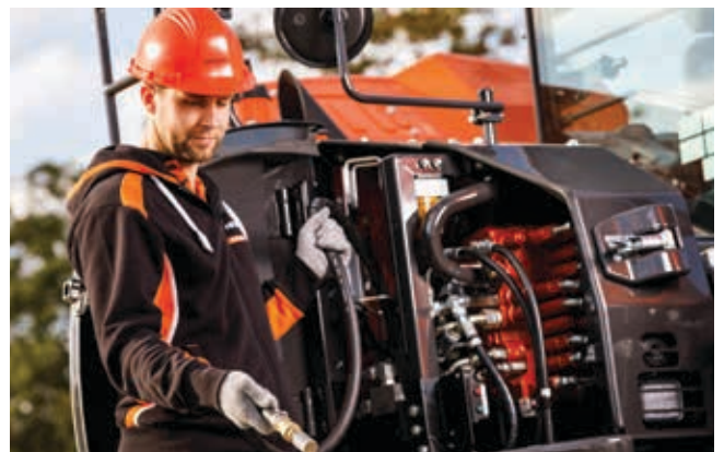
Kaivukoneen tankkaukseen voi käyttää sähköistä pumppua.
