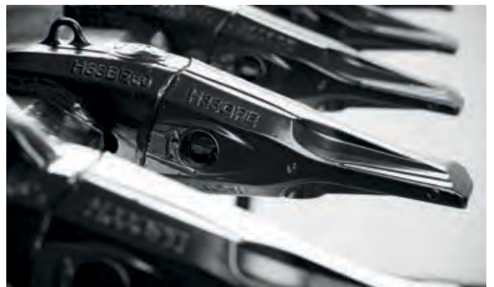
Hitachin kaivutyövälineisiin kuuluu mm. itseterottuvat kynnet ja luotettavat adapterit, jotka varmistavat tarkan sopivuuden.
