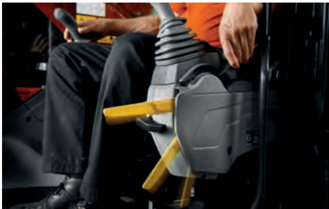
Esiohjauksen turvalukitusvipu tarjoaa parempaa turvallisuutta ohjaamossa.
