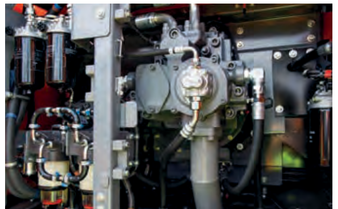
HIOS V -hydraulijärjestelmällä saavutetaan jopa 11 %:n polttoainesäästö.
