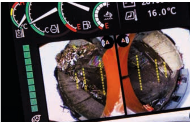
ECO-mittari auttaa saavuttamaan paremmat kulutuslukemat.
