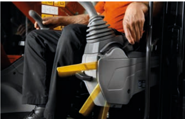
Esiohjauksen turvalukitusvipu tarjoaa parempaa turvallisuutta ohjaamossa.
