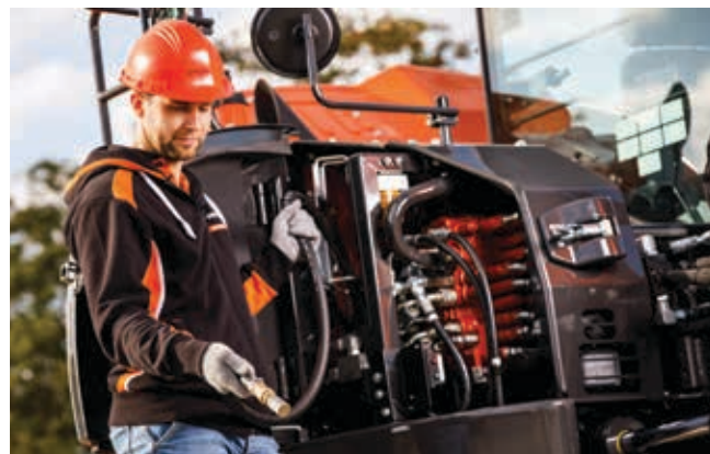
Kaivukoneen tankkaukseen voi käyttää sähköistä pumppua.
