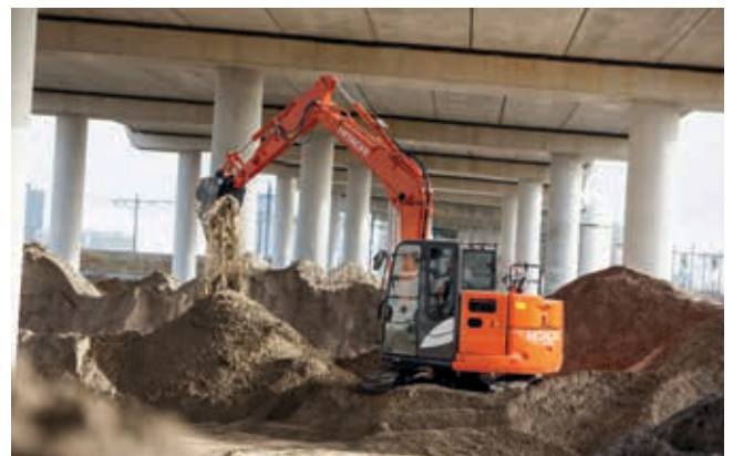
Perän pieni kääntösäde tekee ZX85USB-6:sta ihanteellisen ahtaalle työmaalle.
