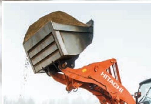
Virtauksenohjausjärjestelmä varmistaa nostovarren pehmeät liikkeet.
