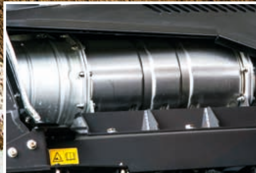
SCR-järjestelmä vähentää päästöjä ja alentaa melutasoa.
