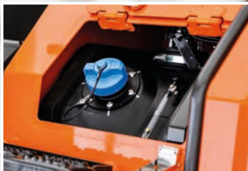
Ureaa ruiskutetaan pakokaasun sekaan vähentämään päästöjä.
