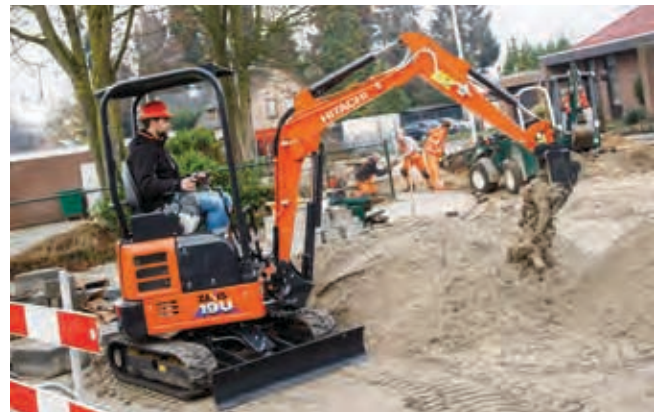
Perän pieni kääntösäde on ihanteellinen ahtaissa tiloissa työskenneltäessä.
