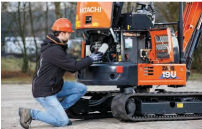
Helposti avattavat luukut nopeuttavat huoltoja.
