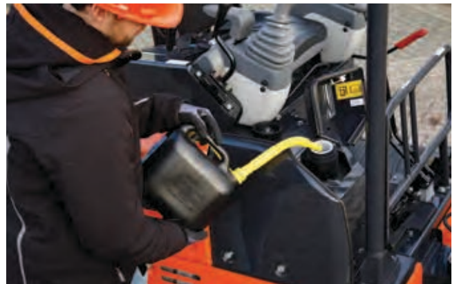
Riittävä tila täyttöaukon ympärillä helpottaa tankkausta.
