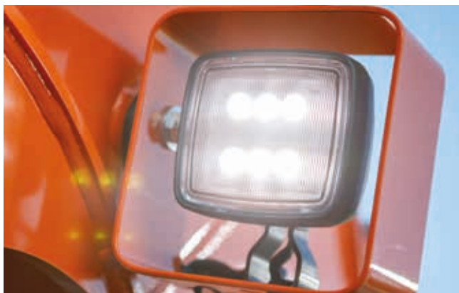
LED-valojen käyttöikä on vastaavia halogeenivaloja pidempi.
