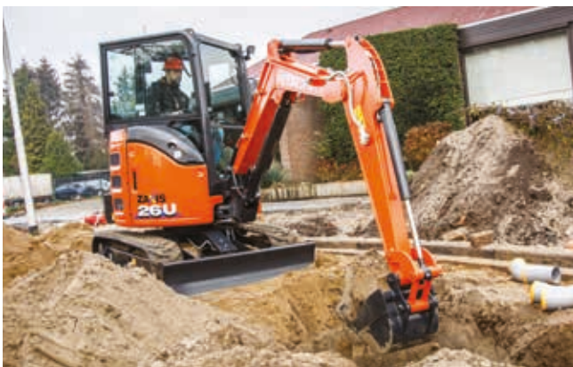
Koneen kaivulaitteeseen on asennettu puomisylinterin suojus, joka lisää kestävyyttä.
