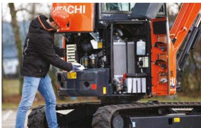
Helposti avattavat luukut nopeuttavat huoltoja.
