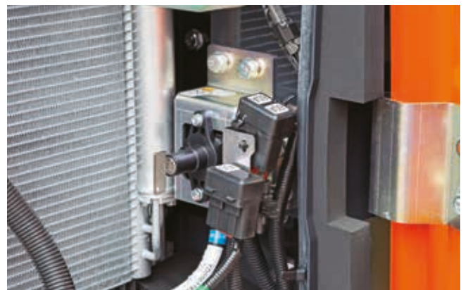
Akun päävirtakatkaisimen ansiosta huollot voidaan tehdä turvallisesti.
