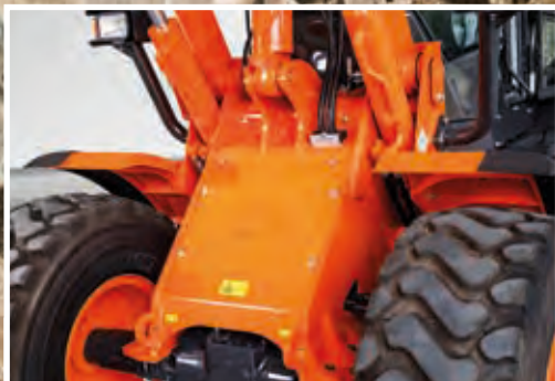
ZW150-6:n eturunkoa on vahvistettu.
