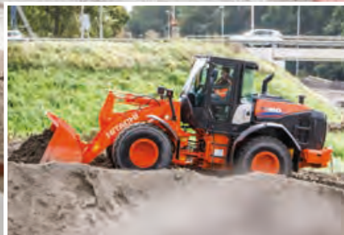
Uusi moottori ja SCR-järjestelmä pienentävät päästöjä.
