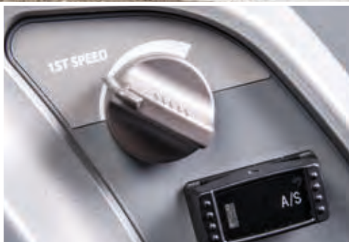
Ykkösvaihteen nopeudensäädin optimoi suorituskyvyn erilaisissa työympäristöissä.
