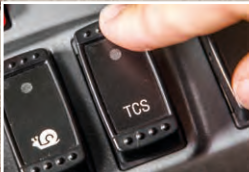
Luistonestojärjestelmä auttaa estämään renkaiden luistoa liukkailla pinnoilla.
