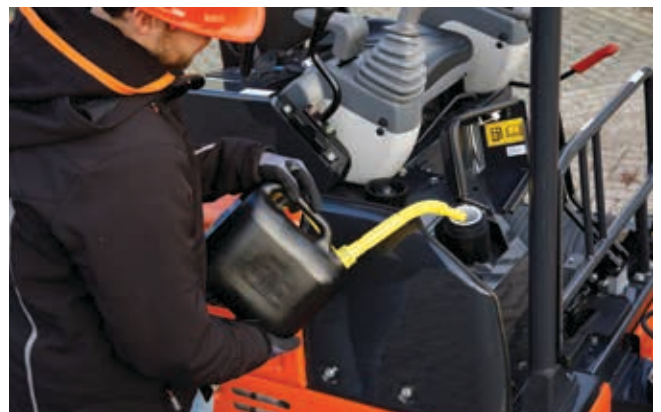
Riittävä tila täyttöaukon ympärillä helpottaa tankkausta.
