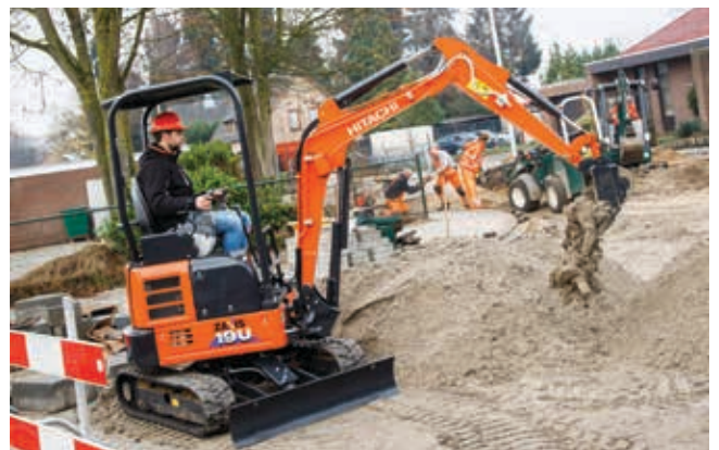
Perän pieni kääntösäde on ihanteellinen ahtaissa tiloissa työskenneltäessä.
