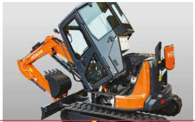
Saranoidun lattian ansiosta moottorin ja ohjausventtiileiden huolto käy nopeasti.
