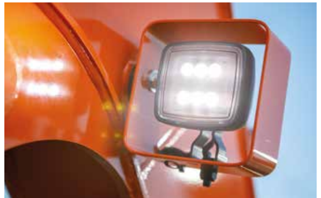
LED-valojen käyttöikä on vastaavia halogeenivaloja pidempi.
