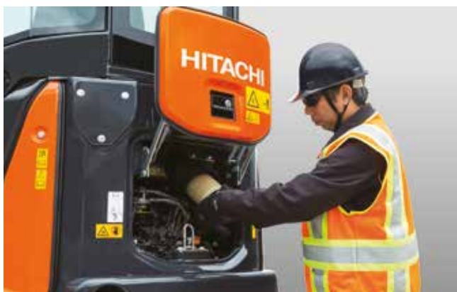
Helposti avattavat luukut nopeuttavat huoltoja.
