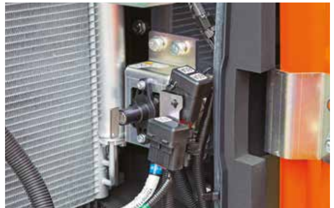
Akun päävirtakatkaisimen ansiosta huollot voidaan tehdä turvallisesti.
