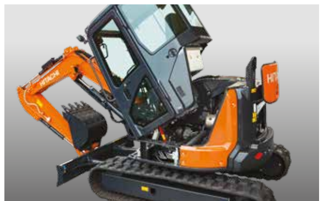
Saranoitun lattian ansiosta moottorin ja ohjausventtiileiden huolto käy nopeasti.
