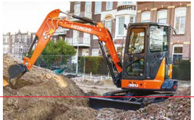
Perän pieni kääntösäde tekee ZX33U-6:sta ihanteellisen ahtaisiin tiloihin.
