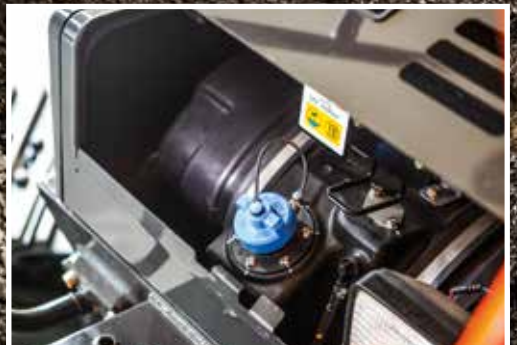
Ureaa ruiskutetaan pakokaasuun päästöjen vähentämiseksi.
