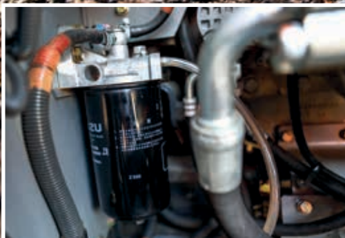
Polttoaineen pääsuodatin on helpompi vaihtaa.
