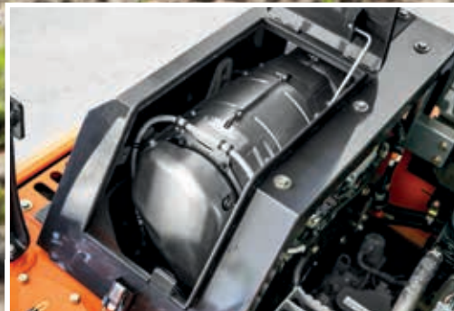
SCR-järjestelmä pienentää päästöjä ja melua.
