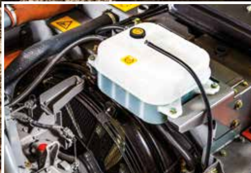
Paisuntasäiliö estää moottorin osien ylikuumenemisen.
