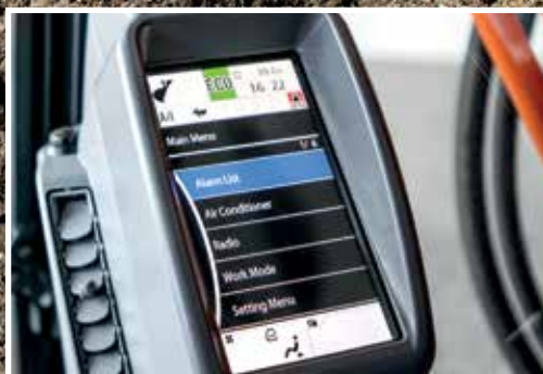
LCD-näytöllä näkyvät koneen tila ja asetukset.
