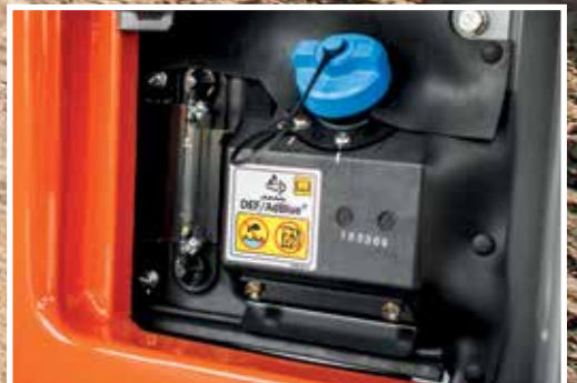
Ureaa ruiskutetaan pakokaasuun päästöjen vähentämiseksi.
