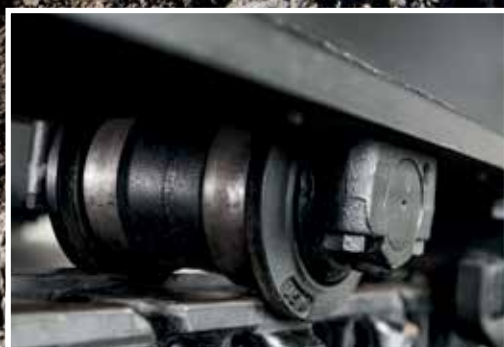
Uusi alarullien rakenne estää mudan tunkeutumista ja siitä aiheutuvia vaurioita.
