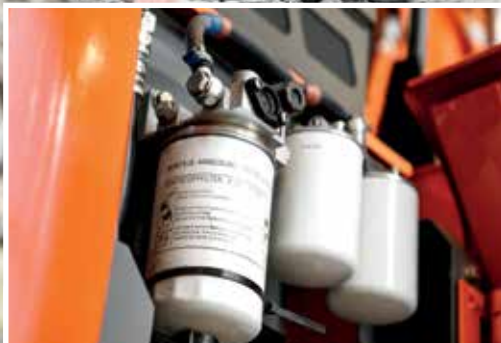
Polttoaineen pääsuodatin on helpompi vaihtaa.
