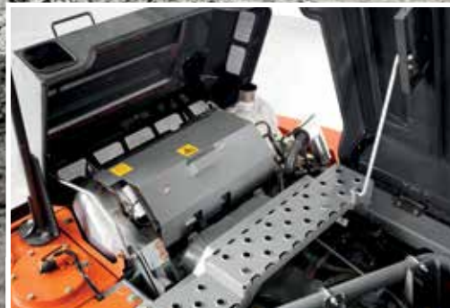
SCR-järjestelmä pienentää päästöjä ja melua.
