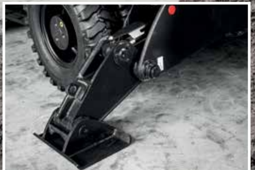
Vahvistettu etuterän sylinterin suojakansi parantaa luotettavuutta.
