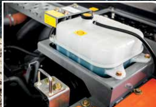
Paisuntasäiliön uusi sijainti estää moottorin ylikuumenemisen.
