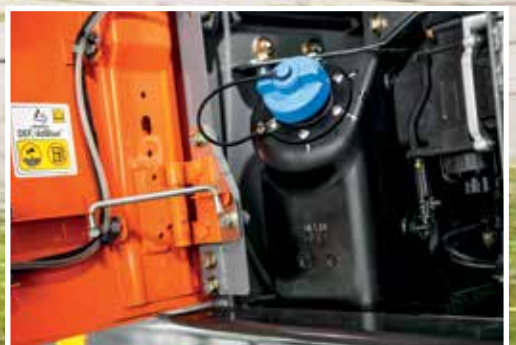
Ureaa ruiskutetaan pakokaasuun päästöjen vähentämiseksi.
