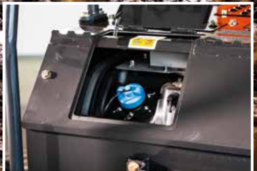
Ureaa ruiskutetaan pakokaasun sekaan vähentämään päästöjä.
