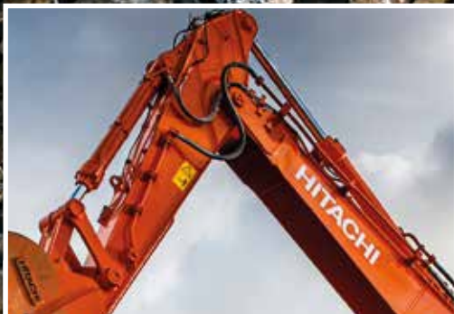
Vahvistettu puomi ja kaivulaite.
