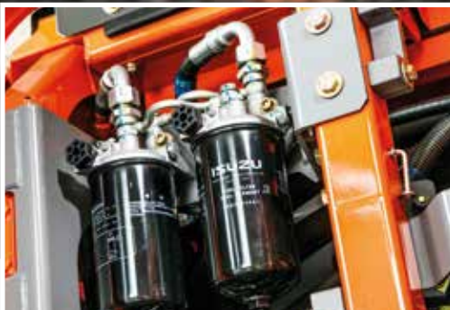
Polttoaineen pääsuodatin on helpompi vaihtaa.
