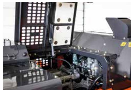
SCR-järjestelmä pienentää päästöjä ja melua.
