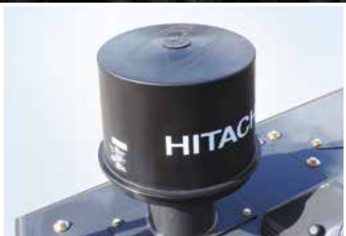
Vähäisempi suodattimen puhdistustarve esipuhdistimen ansiosta (lisävaruste).
