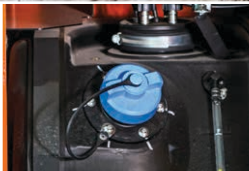
Ureasäiliön huolto on turvallinen ja helppo suorittaa maassa seisten.
