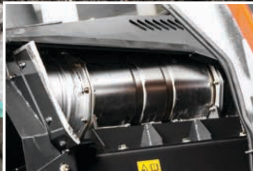
SCR-järjestelmä vähentää päästöjä ja alentaa melutasoa.
