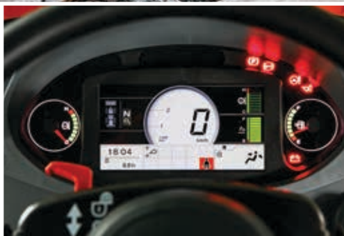
LCD-näyttö näyttää koneen tilan ja asetukset.
