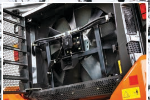
Pitkäikäiset jäähdyttimet ovat korroosionkestäviä.
