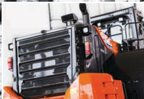
Uusi takasäleikkö suojaa jäähdytintilaa.
